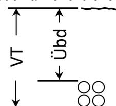
Beim Trenching werden durch Säge- oder Frästechnik verschieden breite und tiefe Schlitze bzw. Gräben direkt in Böden, Asphalt und Beton eingebracht, in welche Rohre mit Glasfaserkabeln eingelegt werden.
